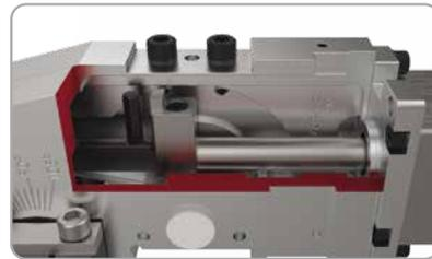
La apertura del brazo de sujeción está fijado actualmente a 105° en la posición cerrada.
