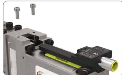
Retire la cubierta o el sensor para acceder al mecanismo de sujeción y ajuste el ángulo de apertura.
